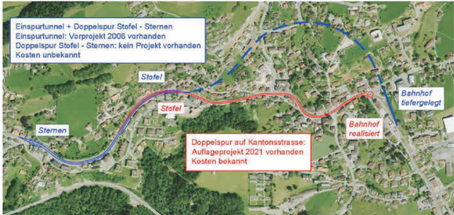
Linienführung Varianten Bahntunnel und Strassenbahn (Doppelspur) Rot: Variante Strassenbahn Blau: Bahntunnel mit Doppelspur Stofel bis Sternen
